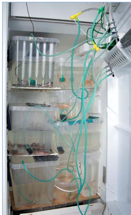
Рис. 3. Размещение контейнеров с глубоководными рыбами в бытовом холодильнике на борту судна
