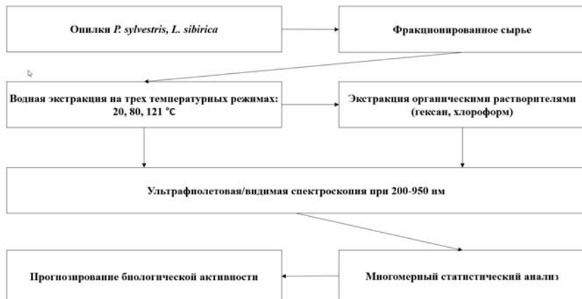
Рис. 1. Схема исследования древесных отходов методом УФ-Вид спектроскопии
