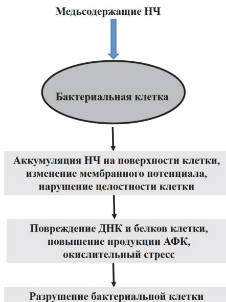
Рис. 2. Схема антибактериального механизма медьсодержащих НЧ
