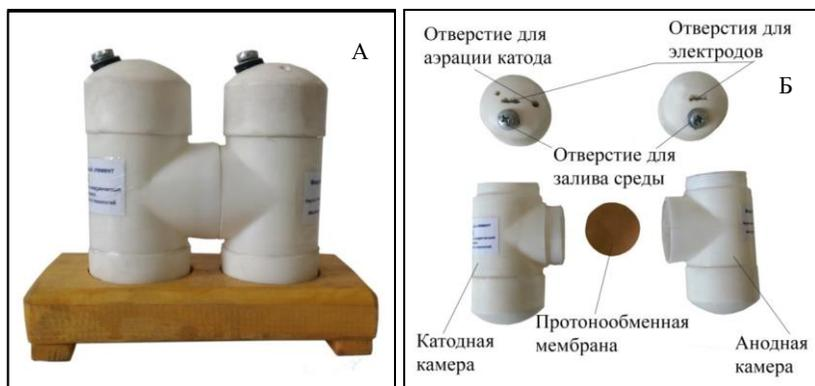
Рис. 8. Двухкамерный БТЭ из ПВХ-деталей сантехнического назначения (опытная конструкция № 5) в собранном (А) и разобранном (Б) виде
