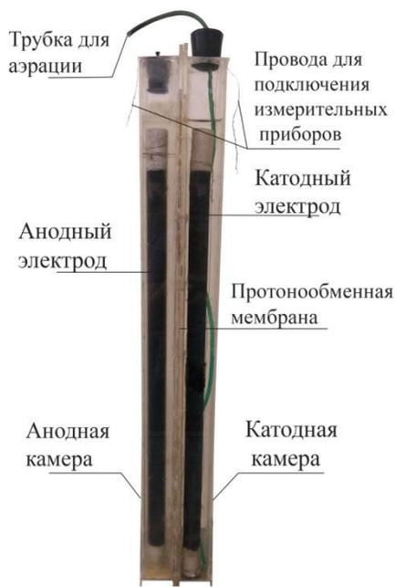
Рис. 5. Ячейка БТЭ (опытная конструкция № 4)
