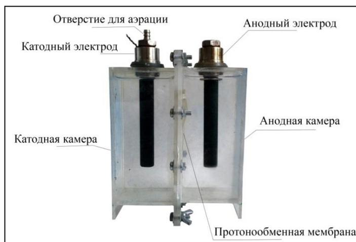
Рис. 1. Двухкамерный БТЭ из оргстекла (опытная конструкция № 1)
