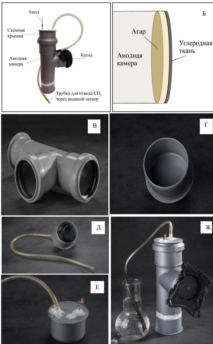
Рис. 11. Однокамерный БТЭ (опытная конструкция № 6). А – однокамерный БТЭ в собранном виде; Б – схема устройства катода; В – Т-образный тройник для внутренней канализации из полипропилена, служащий рабочей камерой БТЭ; Г – заглушка для верхней части БТЭ. Крышка рабочей камеры однокамерного БТЭ с трубкой для отвода газов и медным проводом 20 AWG OD (1,8 мм) для прикрепления анодного электрода: Д – вид изнутри; Е – вид снаружи; Ж – установка в работе [Zhdanova, Dukhnov, Stom, 2018]
