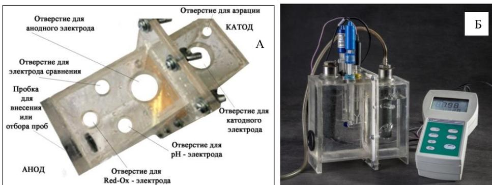
Рис. 3. Модифицированный БТЭ, позволяющий измерять рН- и Ох-Red-потенциал анолита (опытная конструкция № 3). А – схема устройства БТЭ [Stom, Zhdanova, Kashaevskii, 2017]; Б – БТЭ в работе с подключенными измерительными электродами и рН-метром-иономером
